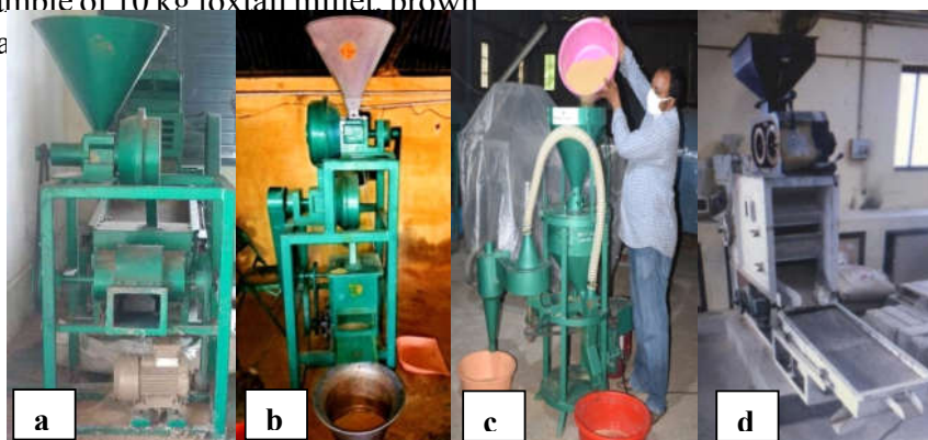
Fig. 1 TNAU single chamber centrifugal de-huller (a), TNAU double chamber centrifugal de-huller (b), CIAE millet mill (c) and Rubber roll sheller (d)
